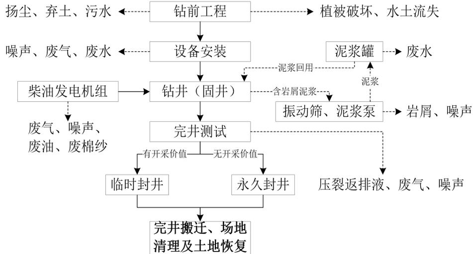
图2 项目主要工艺流程及产污环节图
