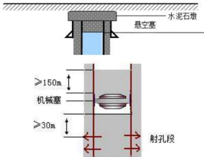
图 6 井口及射孔封堵示意图
