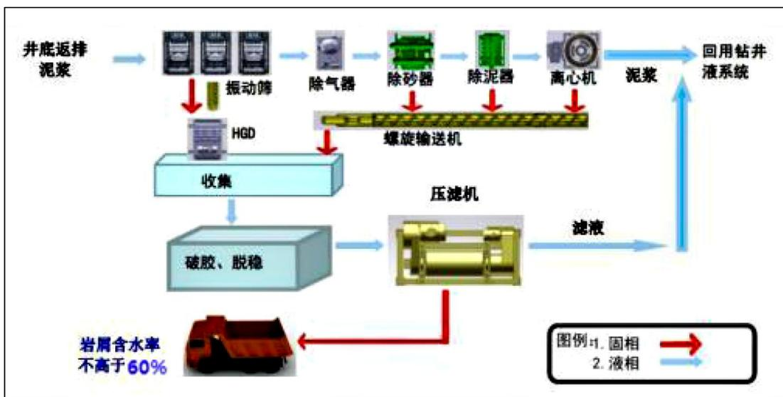
图3 泥浆闭路循环系统示意图
